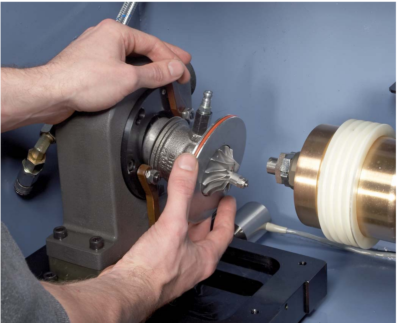
Фиксация среднего корпуса компрессора
