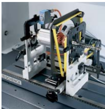
Балансировочный станок серии HM 10 с накидным ременным приводом
